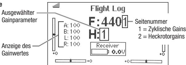
Haben Sie das Gain Menü aktiviert bewegen Sie den Taumelscheibensteuerknüppel nach rechts und links um die Parameter einzustellen. Bewegen Sie den Steuerknüppel nach rechts wählen Sie den nächsten Parameter aus, bewegen Sie den Steuerknüppel nach links wählen Sie den vorherigen Parameter.
